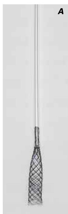
Рис. 2 Стент из никелида титана. А – расправление стента при выведении из интродьюсера; В – стент в расправленном виде
