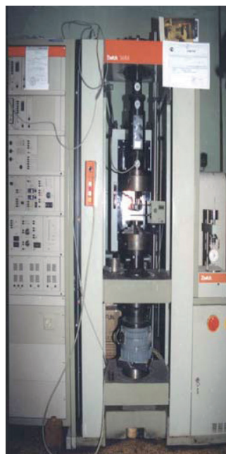
РИС.3.УНИВЕРСАЛЬНАЯ ИСПЫТАТЕЛЬНАЯ МАШИНА ЦВИК-1464 (СЛЕВА) И ВИБРОТРИБОМЕТР «ОПТИМОЛ SRV» (СПРАВА)
