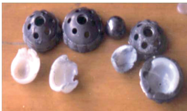
РИС. 7. ПОЛИМЕРНЫЕ ЧАШКИ, ИЗВЛЕЧЁННЫЕ ИЗ СУСТАВОВ ПАЦИЕНТОВ ПОСЛЕ РАЗРУШЕНИЯ
