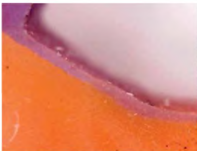
Рис. 1 Измерение толщины силиконовой плёнки при помощи калиброванного цифрового микроскопа (объяснение в тексте)
