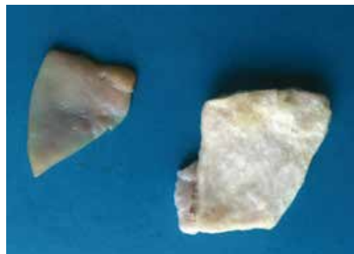
Рис. 2 ФК до и после обработки пергидролем
